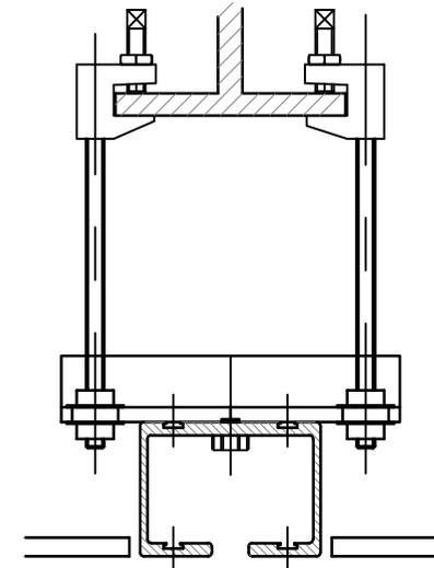
**3. FIXED TO STEEL BEAM USING 'LINDAPTER CLAMPS'**
